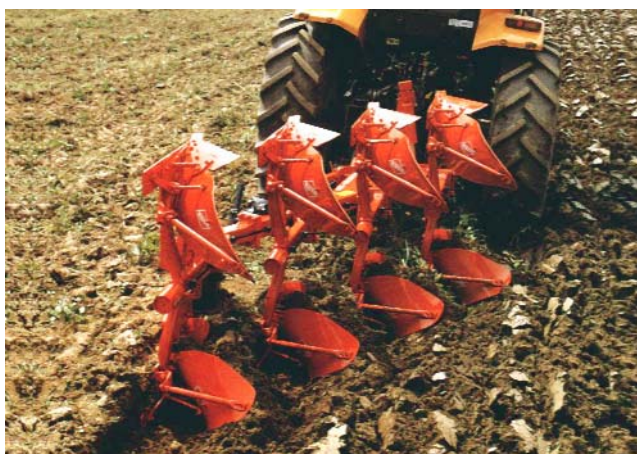
Master 102 NSN (KUNHN) Плуг навесной оборотный мощность трактора 84 кВт безостановочные предохранители NSH Ширина захвата корпуса 35 и 40 см Высота под рамой 70 и 75 см Расстояние между корпусами 90 см Тип отвалов цилиндрический, винтовой, полосовой Регулировка предплужников в трех направлениях
